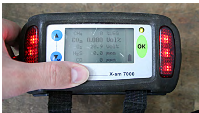
Abb. 1: Mehrgaswarngerät für fünf Parameter
