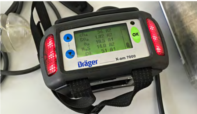
Abb. 3: Betriebsbereit für die Messung aller relevanten Gase
